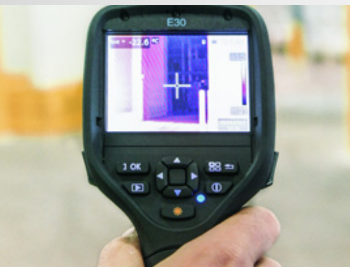
Thermografische meting met luchtdeur ingeschakeld
